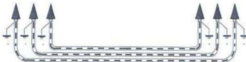
Ilustración 10. Puesta a tierra cubiertas metálicas
